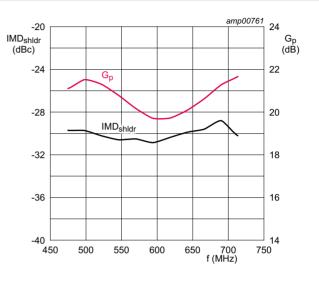
$P_{L(AV)} = 150 \text{ W}$ ;  $V_{DS} = 50 \text{ V}$ ;  $I_{Dq} = 2 \times 650 \text{ mA}$ .
